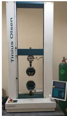
الشكل رقم (8): يظهر جهاز Olsen 50 الذي تم استخدامه لاختبار مقاومة انكسار أسنان العينة
