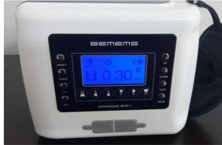
الشكل رقم (4) ( جهاز الأشعة المحمول مع ضبط لحزمة الأشعة)
