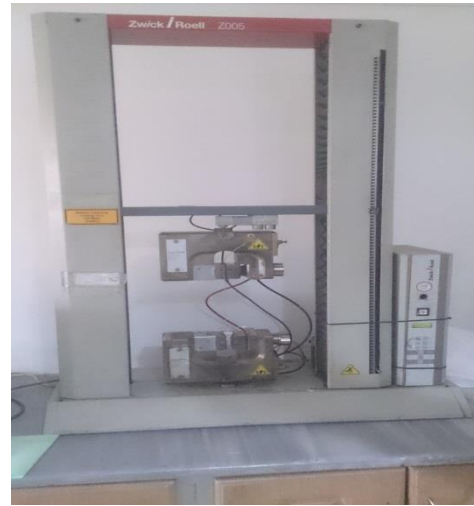
الشكل رقم (5): لجهاز Zwick / Roell اختبار قوة الشد
