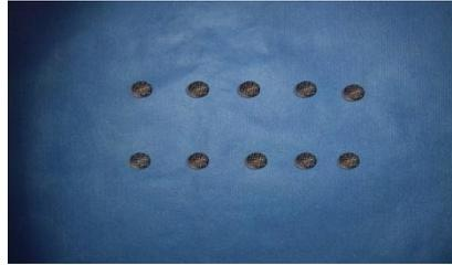
الشكل رقم (2): عينات القساوة المصنوعة بتقنية SLM
