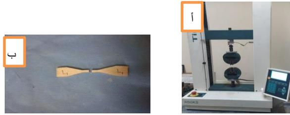
الشكل رقم (8): أ- جهاز اختبار مقاومة الشد ب- عينة اختبار الشد بعد إجراء الاختبار عليها و تحطمتها
