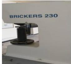
الشكل رقم (3): جهاز قياس القساوة
