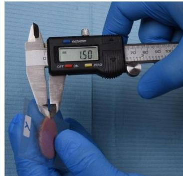
الشكل رقم (10): العلكة بسماكة 1.5 ملم
