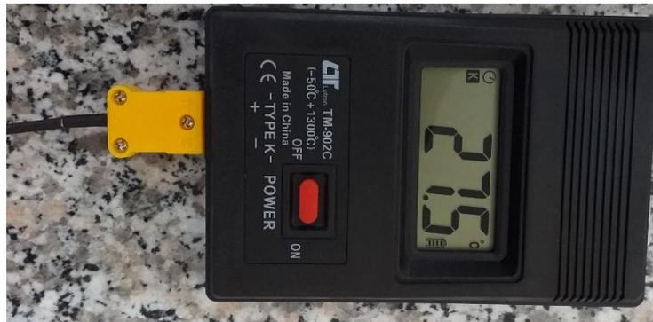
الشكل رقم (1): K type thermocouple
