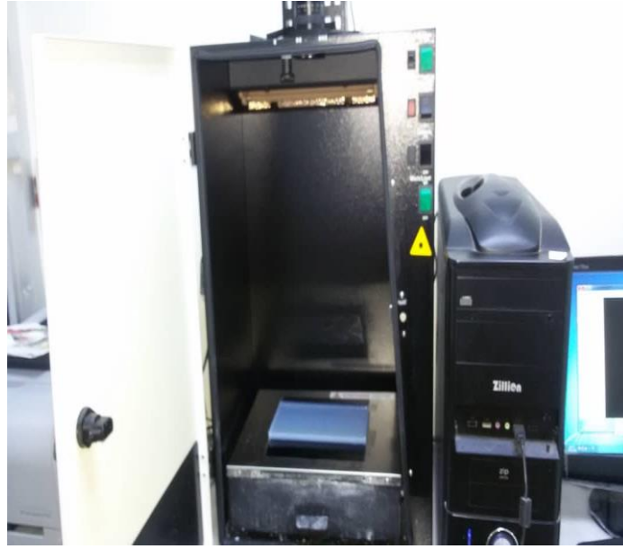
الشكل رقم (3) جهاز توثيق الهلامات Vilber (LourMa) Gel documentation system
