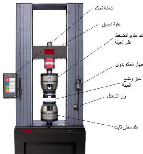
الشكل رقم(1): جهاز قياس مقاومة الانضغاط
