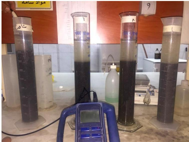
الشكل رقم (3): ترسيب عينات الحمأة المختلطة بعد 60 دقيقة
