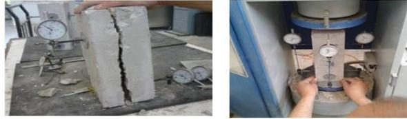
الشكل رقم (3): اختبار معامل المرونة في هذه الدراسة.
