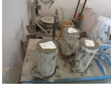
الشكل رقم (20): عملية صب العينة
