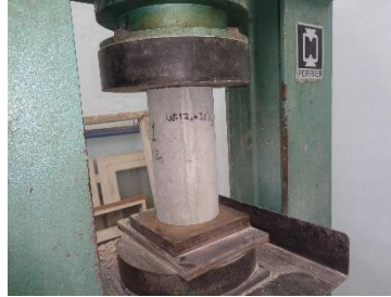
الشكل رقم (21): إختبار العينات للإسطوانية
