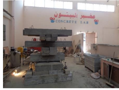
الشكل رقم (22): وضع العينة على الجهاز وتثبيت الحساسات
