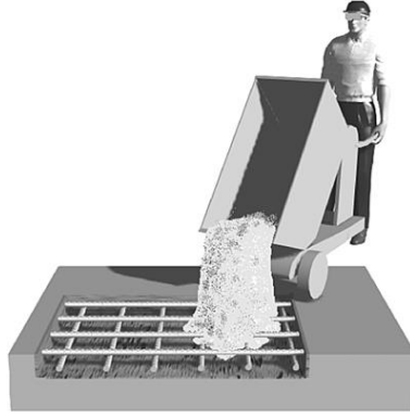
الشكل رقم(7): وضع مواد الإصلاح في التجويف باستخدام عربات
