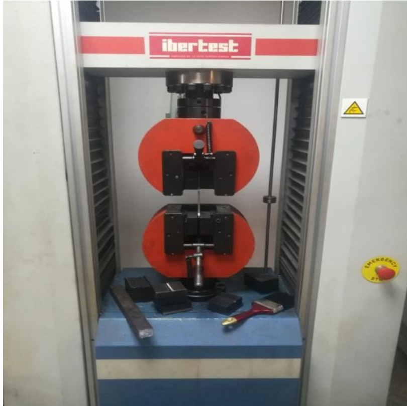
الشكل رقم (8): جهاز اختبار الشد المستخدم
