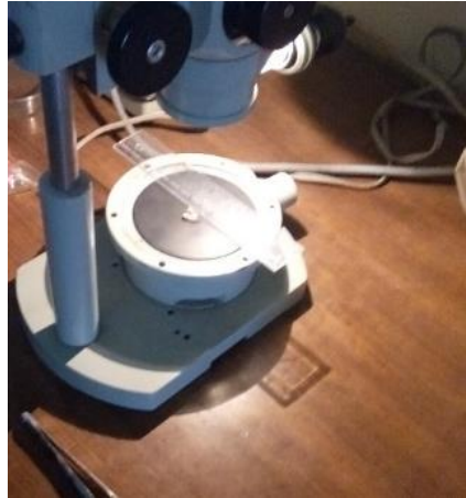
الشكل رقم 2 : مجهر الستيريو المستخدم لكشف التسرب الصباغي.
