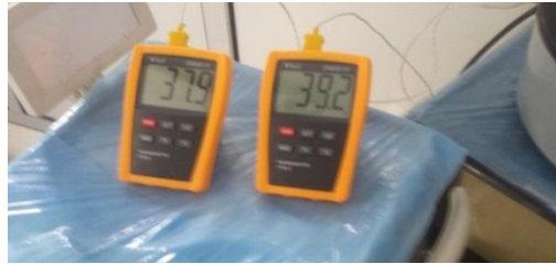
الشكل رقم (1): القراءات الحرارية أثناء إجراء التجارب للنقطتين عند الذروة و قبل 5 ملم من الذروة
