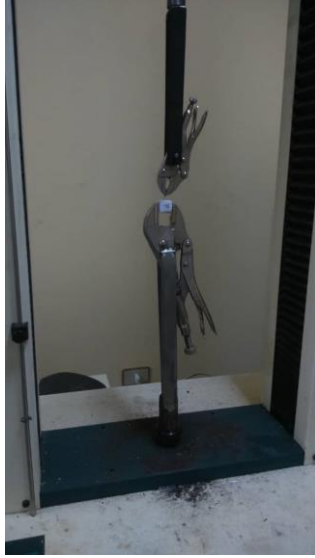
الشكل رقم (7): تثبيت إحدى العينات على الجهاز
