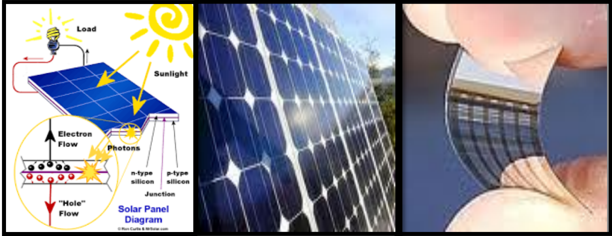
الشكل رقم (7): الخلايا الشمسية وطبقاتها ومرونة تشكيلها -المصدر[16]
