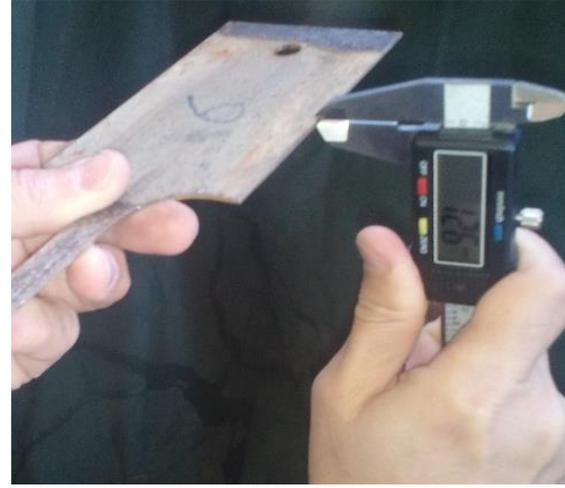
الشكل رقم (7): يوضح إختلاف سماكة العينات الخامية قبل وبعد الغمر نتيجة تشكل الصدأ
