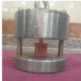
الشكل (17): إلصاق إحدى العينات
