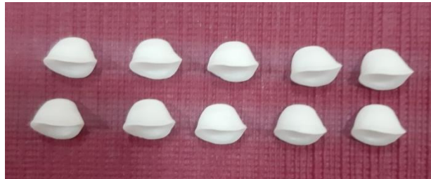
الشكل (10): القبعات الزيركونية بعد التلييد
