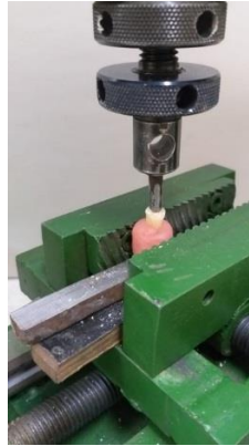
الشكل رقم (7): تطبيق اختبار مقاومة الكسر
