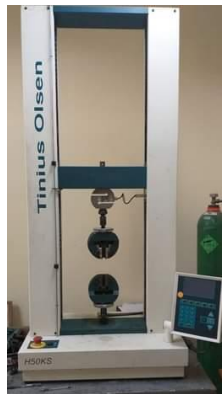
الشكل رقم (7): تطبيق اختبار مقاومة الكسر
