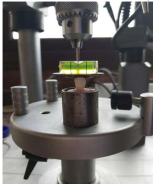
الشكل رقم (2): التأكد من محور العينة وزاويتها
