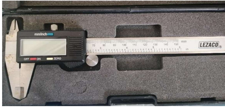
الشكل رقم (4): المسمك الرقمي المستخدم لأخذ القياسات بين النقاط
