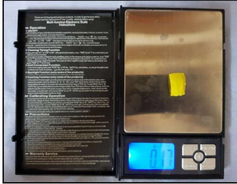
الشكل رقم (13): وزن الرقاقة المطاطية الناتجة باستخدام الميزان الإلكتروني الحساس.
