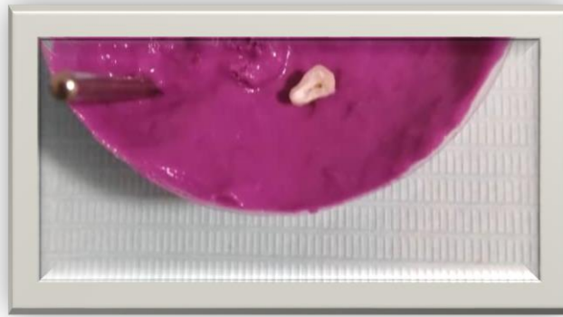
الشكل رقم (3): إدخال جزء معدني لتوفير قطب معاكس
