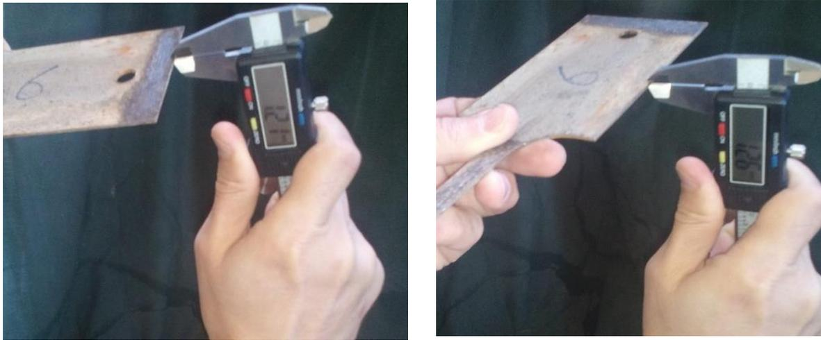
الشكل رقم (7): يوضح إختلاف سماكة العينات الخامية قبل وبعد الغمر نتيجة تشكل الصدأ
