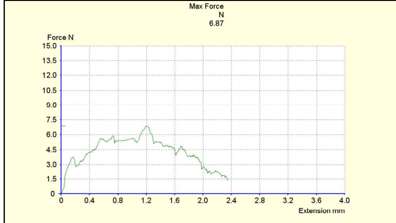
الشكل رقم (14): مخطط قارئ آلة الشد (ضامة مرنة عند عمق تثبيت 0.75 ملم).
