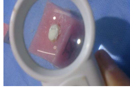
الشكل رقم (7): يظهر نمط فشل ترميم لإحدى العينات بعد إجراء اختبار القص تحت التكبير، الدهد،
