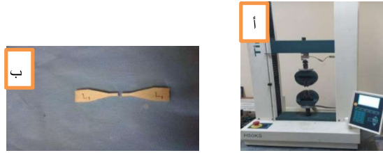
الشكل رقم (8): أ- جهاز اختبار مقاومة الشد ب- عينة اختبار الشد بعد إجراء الاختبار عليها و تحطمها
