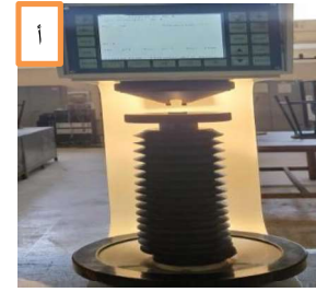
الشكل رقم (4): أ- عينة الاختبار على جهاز قياس القساوة ب- صورة مجهرية للعينة بعد إجراء الاختبار
