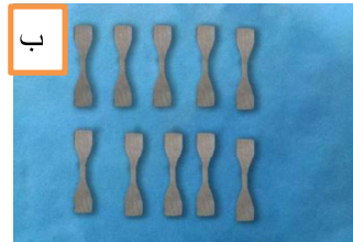
الشكل رقم (6): (أ- النماذج الشمعية لعينات الشد ب- عينات الشد المصنوعة بتقنية CS )
