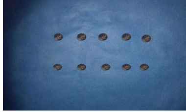
الشكل رقم (2): عينات القساوة المصنوعة بتقنية SLM
