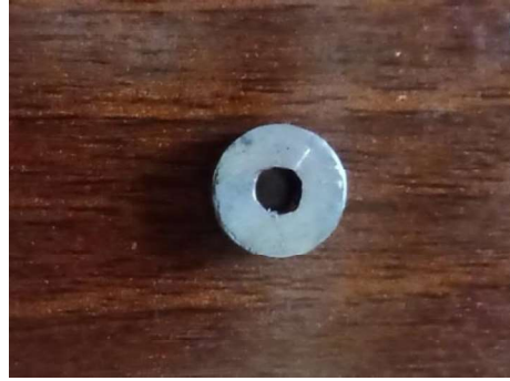
الشكل رقم (2): القالب المعدني المستخدم في صناعة العينات
