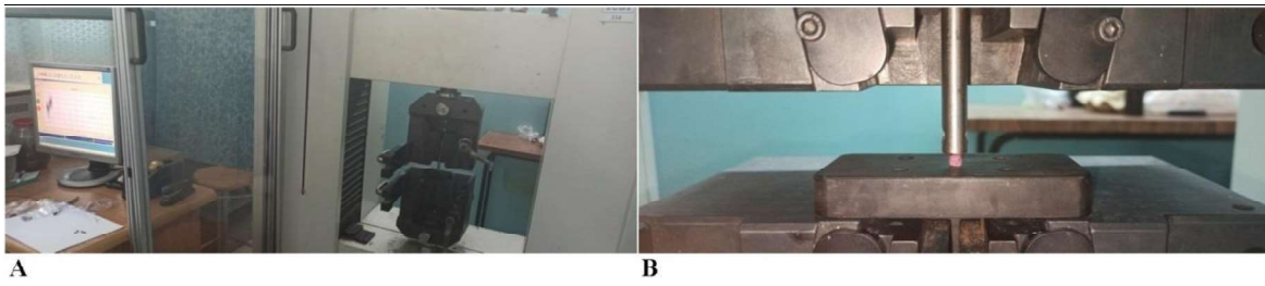
الشكل رقم (4): (A) آلة الفحص المعيارية المستخدمة في البحث. (B) تثبيت العينات ضمن الآلة
