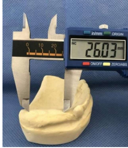
الشكل رقم(5) : قياس المسافة بين النقطتين بواسطة المقياس الرقمي .
