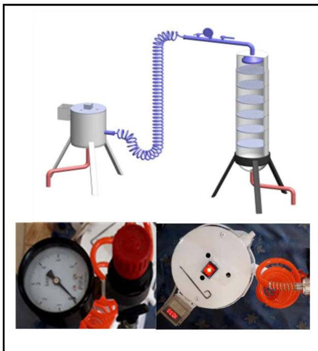
الشكل رقم (10): جهاز الترشيح المستخدم لتقييم الفعالية الماضعة
