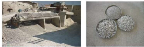
الشكل رقم (6): الكسارة المستخدمة ونتاج فرز الركام الخشن المعاد تدويره
