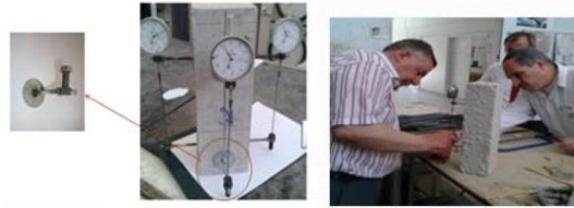
الشكل رقم (2): لصق الحوامل على أسطح المواشير من أجل اختبار معامل المرونة.
