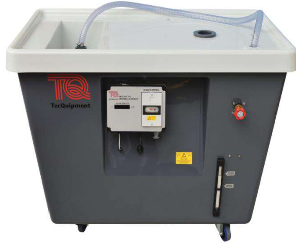
الشكل رقم (2): طاولة التجارب التي يعمل معها جهاز الهدارات لتأمين الغزارة.
