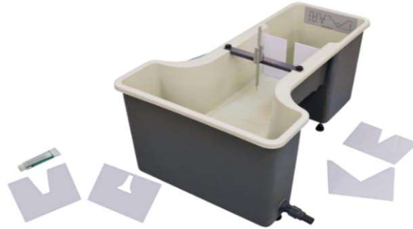
الشكل رقم (1): جهاز الهدارات المستخدم في التجارب المخبرية.
