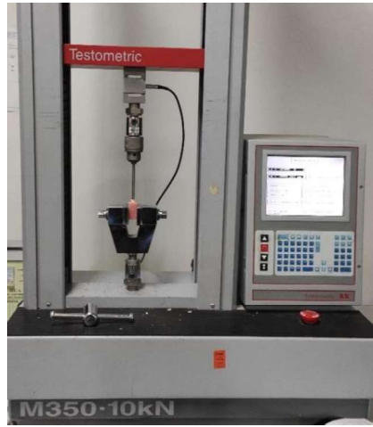
الشكل رقم (3) : تظهر جهاز الاختبارات الميكانيكية Testometric أثناء تطبيق القوى على العينات المختبرة
