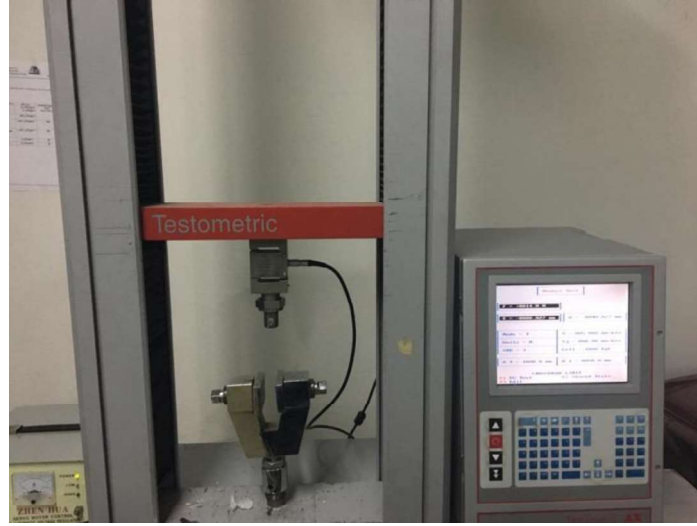
الشكل رقم(1): جهاز الاختبارات الميكانيكية العام Testometric
