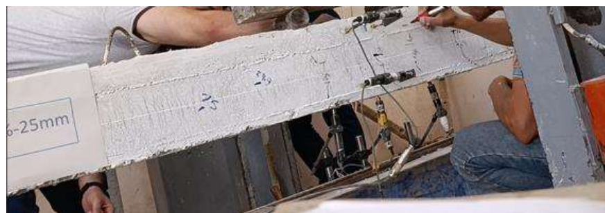
الشكل رقم (6): التحميل الاستثمائي لعينات المجموعة الثانية والثالثة
