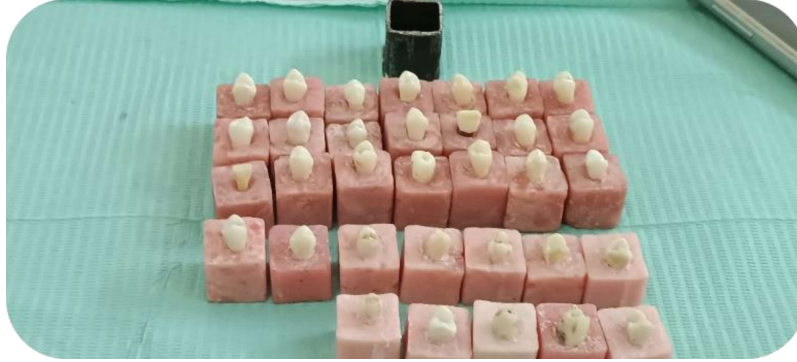
الشكل رقم (2): العينات بعد وضعها ضمن قوالب اكريلية
