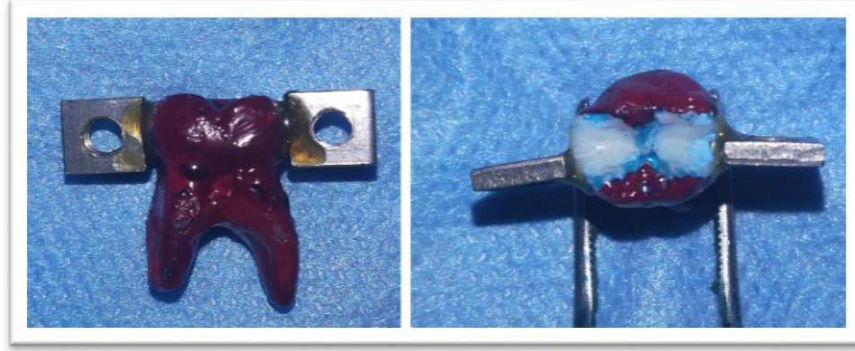
شكل (2): تثبيت الصفائح المعدنية لتحديد مستويات الشطر
