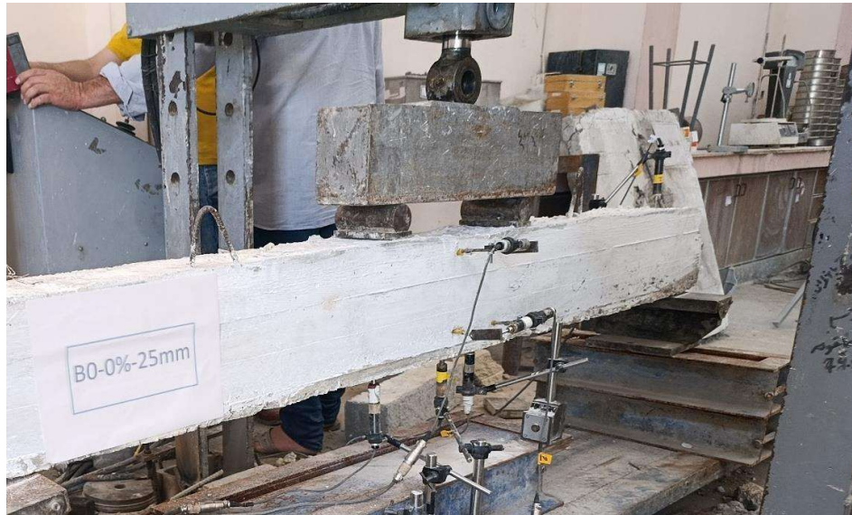
الشكل رقم (8): شكل التحميل للجوائز
