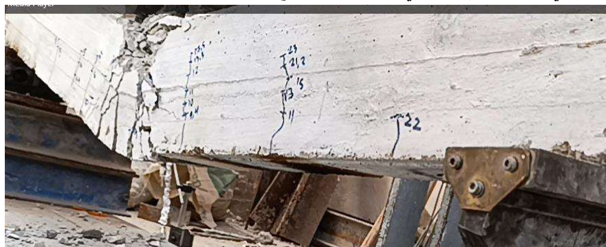
الشكل رقم (5): شكل انهيار جائز مرجعي من المجموعة الأولى
