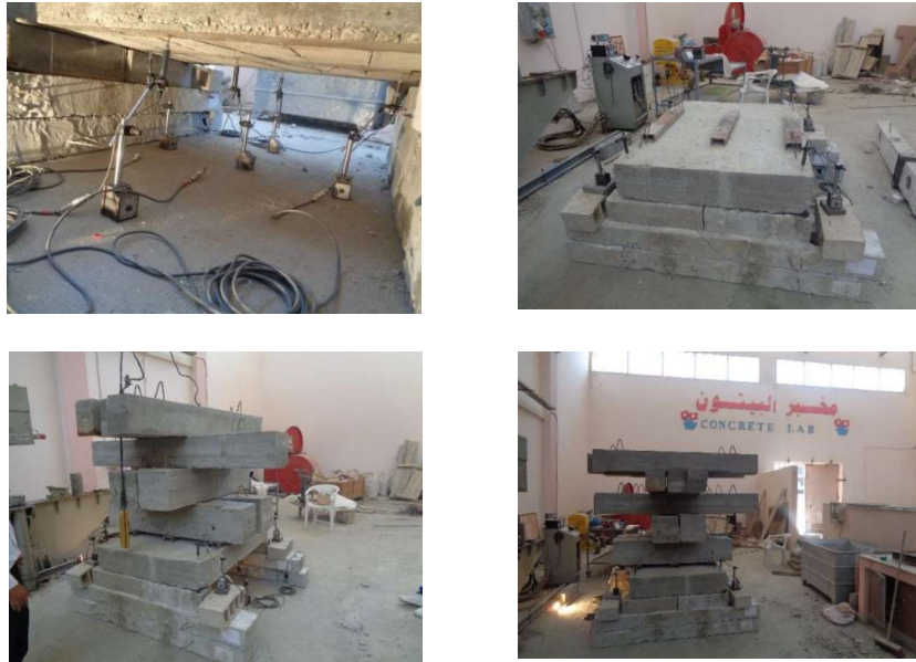
الشكل رقم (22): وضع العينة على الجهاز وتثبيت الحساسات
