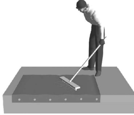
الشكل رقم(8): المسح، ثم تسوية السطح الذي تم إصلاحه
