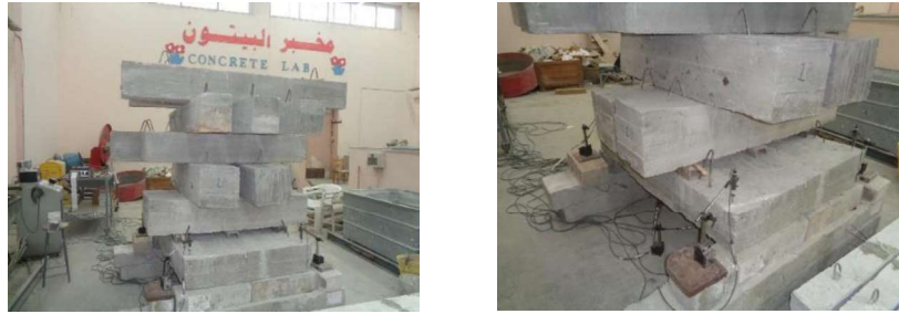
الشكل رقم (30): وضع العينة على الجهاز وتثبيت الحساسات بعد الإصلاح
