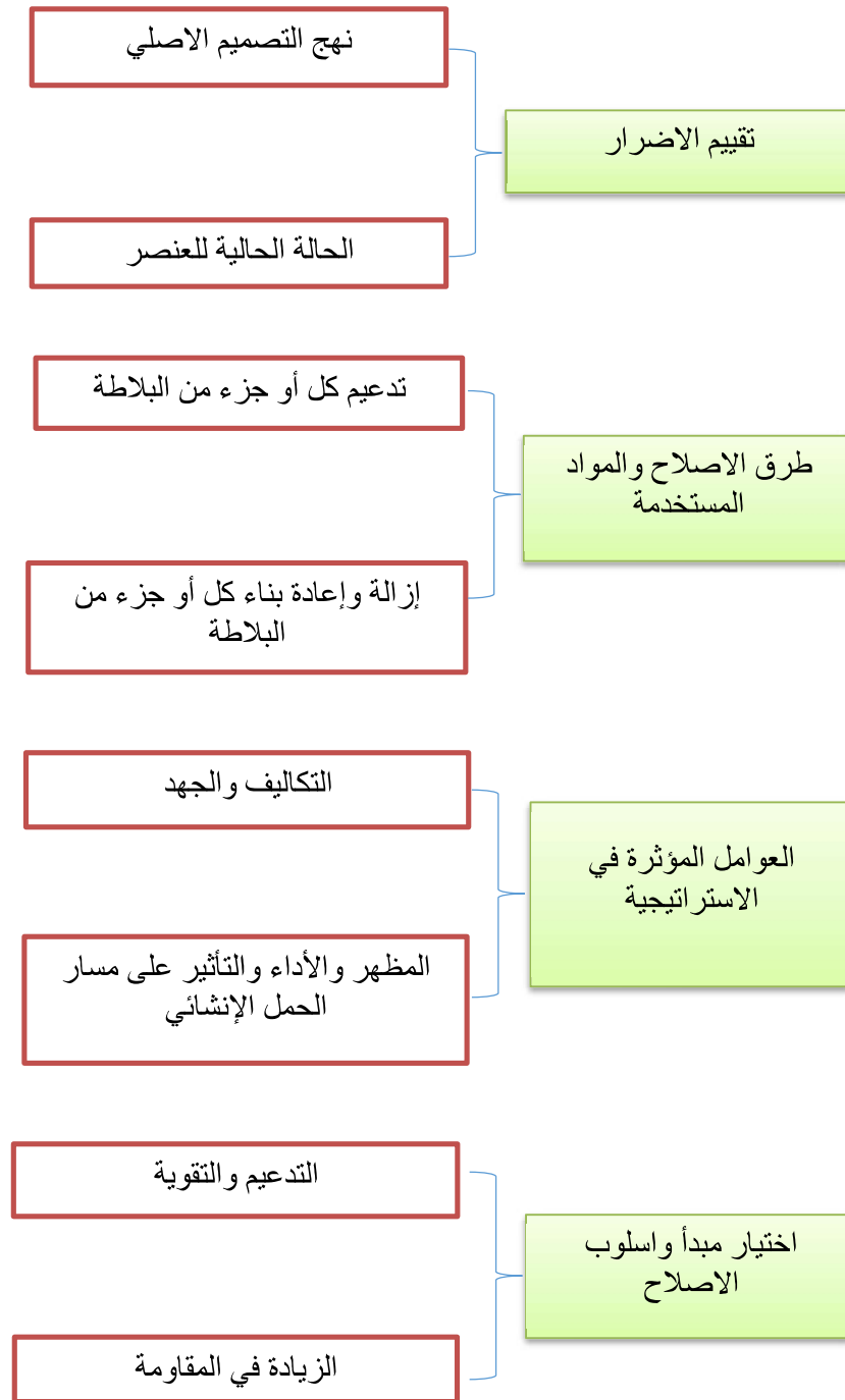
الشكل رقم (1): استراتيجية مراحل تدعيم البلاطة
