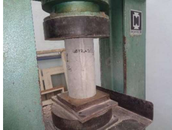
الشكل رقم (21): إختبار العينات للإسطوانية
