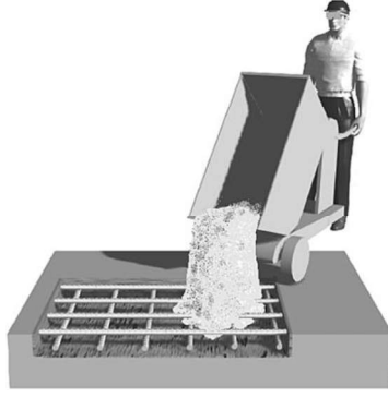
الشكل رقم(7): وضع مواد الإصلاح في التجويف باستخدام عربات
