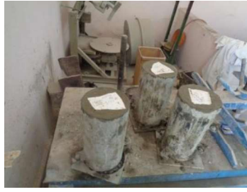
الشكل رقم (20): عملية صب العينة
