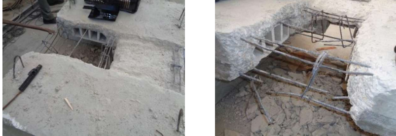
الشكل رقم (27) إجراء التخريب الافتراضي للبلاطة
