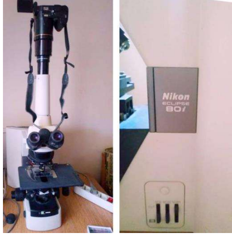
الشكل رقم (8): المجهر الضوئي والكاميرا المستخدمة في عملية الفحص النسيجي للشرائح المجهرية للعينات المدروسة.
