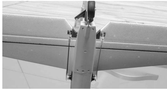
الشكل رقم (3) : تقسيم دفة العمق ووضع سيرفو لكل قسم
