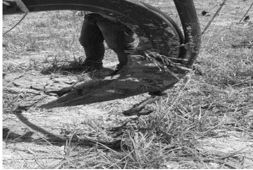
الشكل رقم (1): المفك الميكانيكي مع أنبوب الضخ المثبت في نهايته حتى عمق الحراثة
