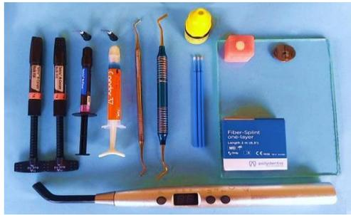
الشكل (4): مجموعة أدوات تحضير عينات اختبار قوة الشد.
