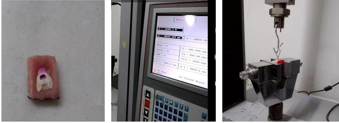
الشكل رقم (15): انجاز اختبار مقاومة الشد، وتسجيل القوة (بالنيوتن) عند حصول الفشل.
