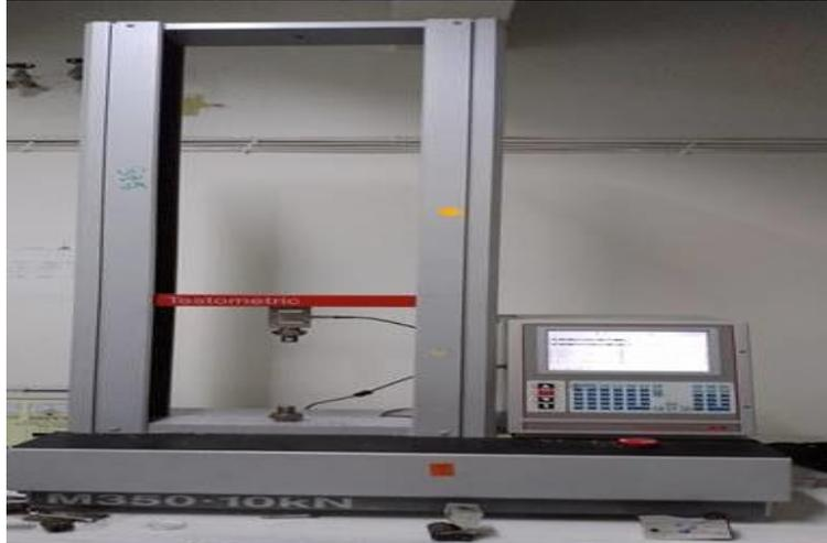
الشكل رقم (14) : آلة الاختبار العالمية (Testometric- universal tasting machine).
