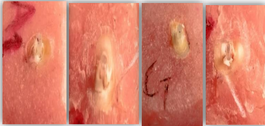
الشكل رقم 5: تظهر بعض العينات بعد إجراء اختبار مقاومة الدفع
