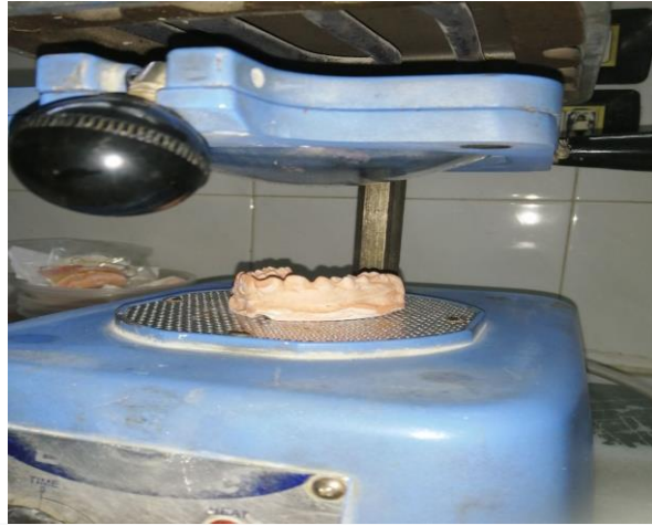
الشكل رقم (2): جهاز التخلية الهوائي (بالشفط)
