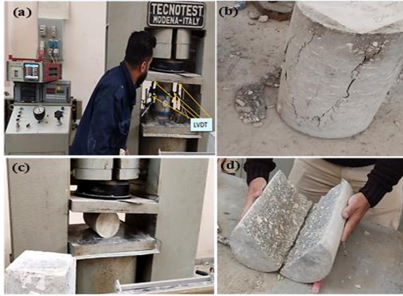
الشكل رقم (6): اختبارات العينات الاسطوانية (a): العينة المعرضة للضغط (b): شكل العينة بعد الانهيار، (c): العينة المعرضة لإجهاد الشد بالفلق (d): شكل العينة بعد الانهيار على الفلق
