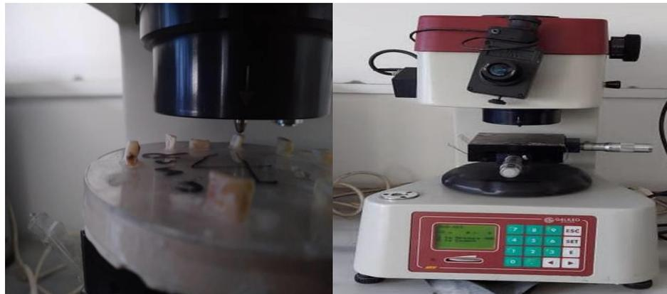
الشكل رقم(8) استخدام جهاز (Galileo durometria) لقياس القساوة السطحية المجهرية للعينات.
