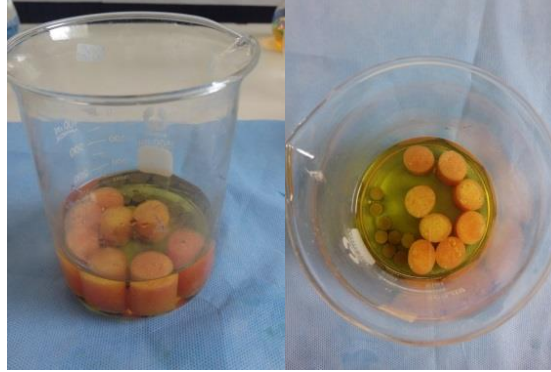
الشكل رقم (2): العينات داخل وعاء زجاجي حاوي على محلول الماء الملكي
