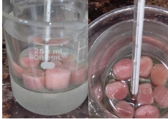
الشكل رقم (3): العينات داخل المحلول الحمضي (H 2 SO 4 +HCl) مع الحفاظ على درجة حرارة 70 درجة مئوية أثناء التخریش.
