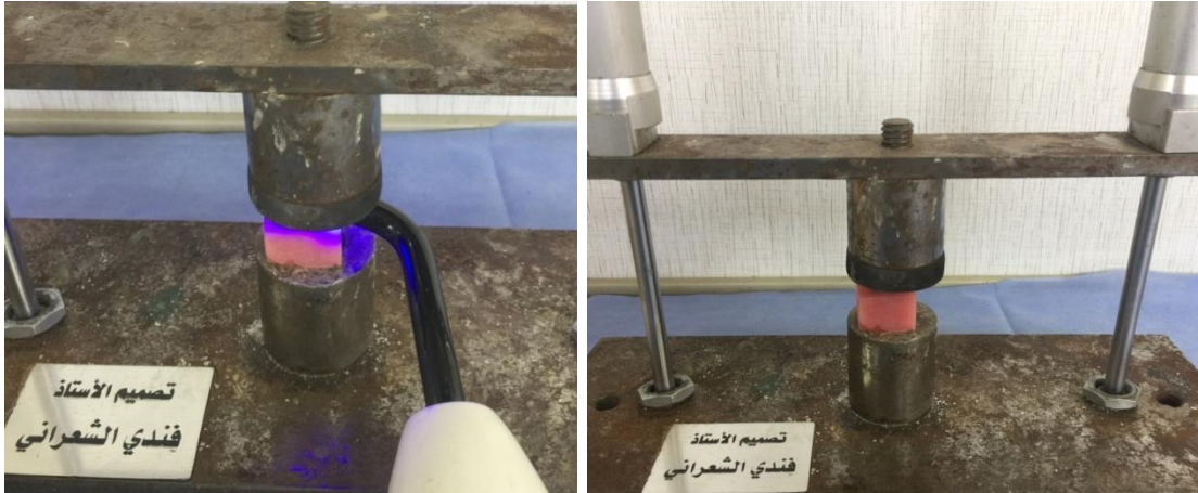
الشكل رقم (4): جهاز تطبيق الضغط وتصليب الإسمنت الراتنجي ضوئياً
