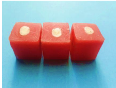
الشكل (10): صورة تظهر نمط فشل الارتباط لإحدى العينات.
