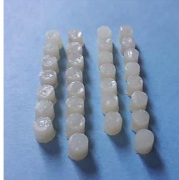
الشكل رقم (5): عينات اختبار القساوة المجهرية (HV).
