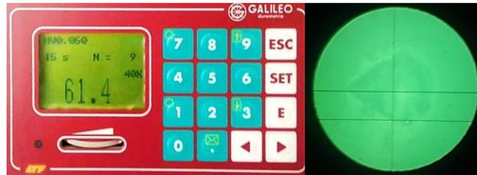
الشكل رقم (7): صورة مجهرية تظهر الانطباع الهرمي لهرم جهاز القساوة المجهرية (HV) لأحد العينات والنتيجة المقابلة له.
