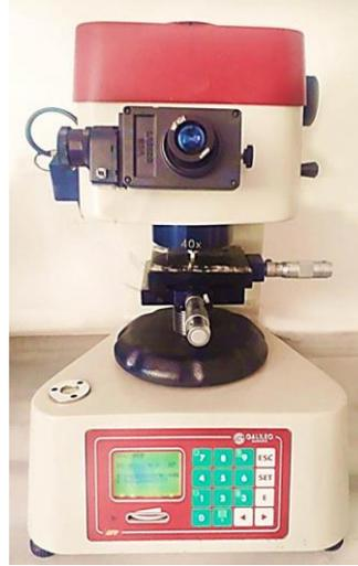
الشكل رقم (6): جهاز اختبار القساوة المجهرية لفيكرز (Galileo Durometria, MOD: Isoscan Vickers .Od)
