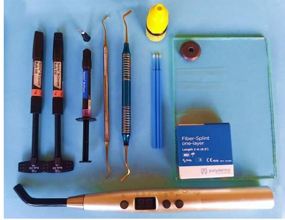
الشكل رقم (2): مجموعة أدوات تحضير عينات اختبار القساوة المجهرية (HV).
