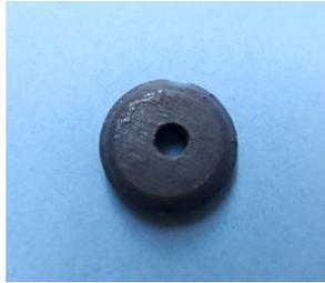
الشكل رقم (1): قالب التيفلون المستخدم في صناعة عينات اختبار القساوة المجهرية (HV).
