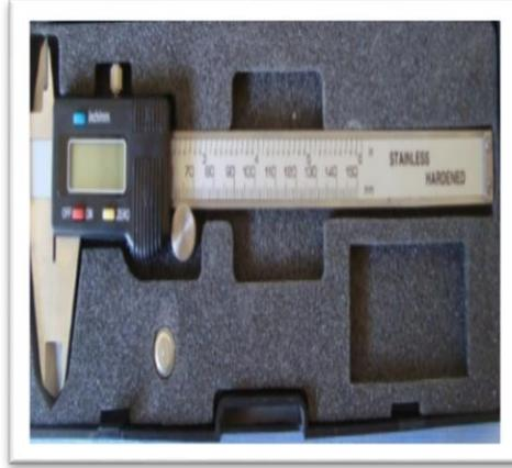
الشكل رقم(5): المقياس الرقمي الالكتروني
