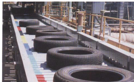
الشكل رقم (3): استخدام النفايات كوقود رديف في صناعة الإسمنت
