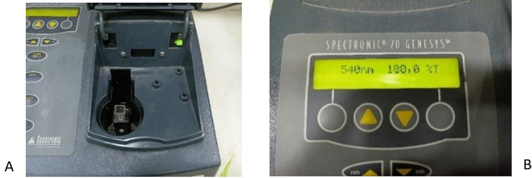
الشكل رقم (8): (A) الحجرة التي يوضع فيها أنبوب كيوفيت، (B) تحديد طول الموجة والخيار %T لمعايرة الجهاز.
